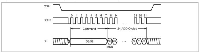
Figure 28. Chip Erase (CE) Sequence (Command 60 or C7)
